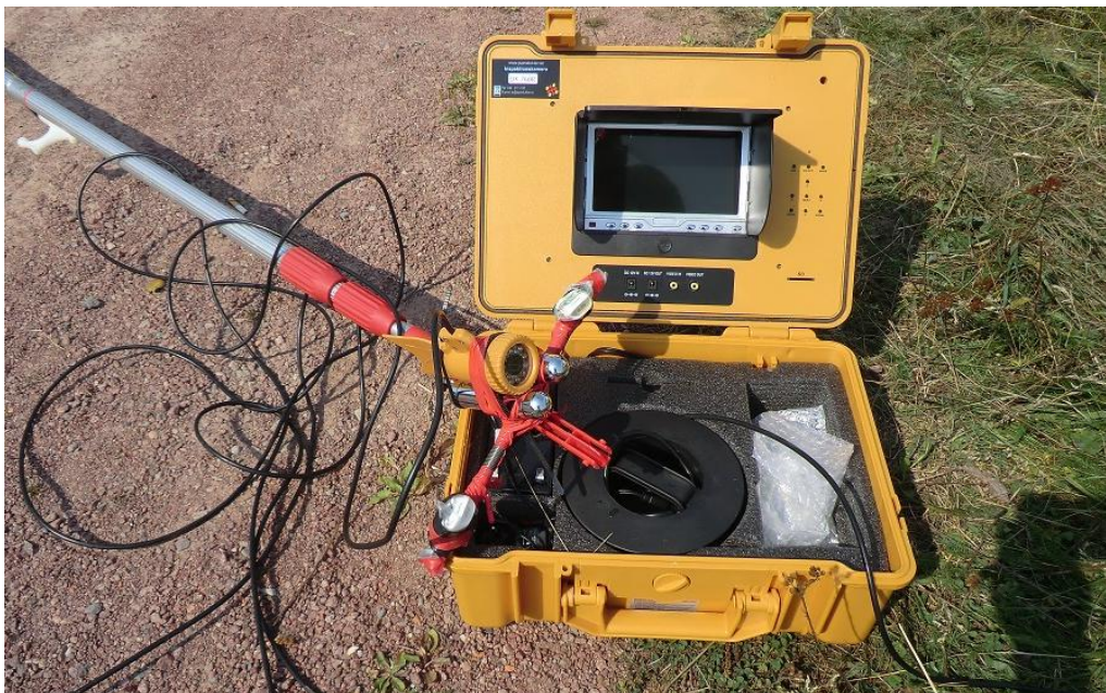
Figur 5. Undervattenskamera med videoanslutning för undervattenshabitat
